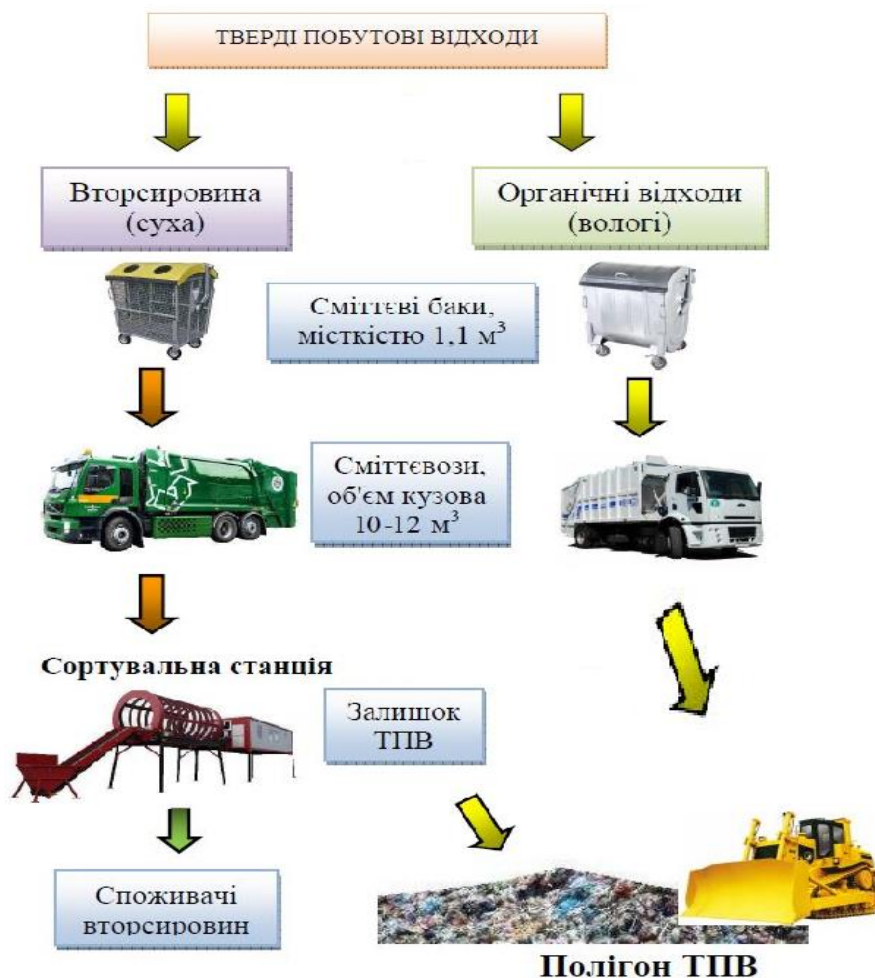
Рис. 2.6 Схема сортування ТПВ на 2 потоки
